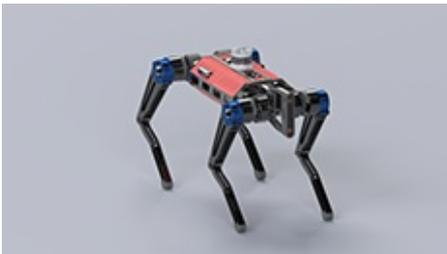
Scotty ist eine mobile vierbeinige Roboterplattform, die für den Einsatz in Bildung und Forschung entwickelt wurde. Der Roboter ist mit Fähigkeiten zur Fortbewegung, Kartierung und Navigation sowie zur Interaktion mit der Umwelt ausgestattet. Die Plattform kann daher in Umgebungen eingesetzt werden, in denen Menschen über interaktive und intuitive Benutzerschnittstellen zusammenarbeiten. Dazu ist der Roboter mit verschiedenen Sensoren (LIDAR, etc.) und drehmomentstarken Motoren ausgestattet.
