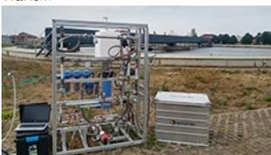
Wasseraufbereitung mit katalytischen Membranen
