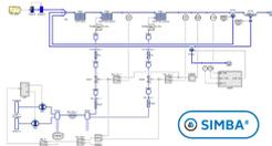
Integrierte Simulation von Kläranlagen kombiniert Simulationsmodelle des Verfahrens (biologische Abwasserreinigung) mit Modellen der technischen Ausrüstung (Stellventile, Gebläse) mit Simulationsmodellen der Automatisierungstechnik. Dieser "Digitale Zwilling" unterstützt die integrierte Planung von Automatisierungssystemen gemeinsam mit der Verfahrensplanung und Auslegung der technischen Ausrüstung.
