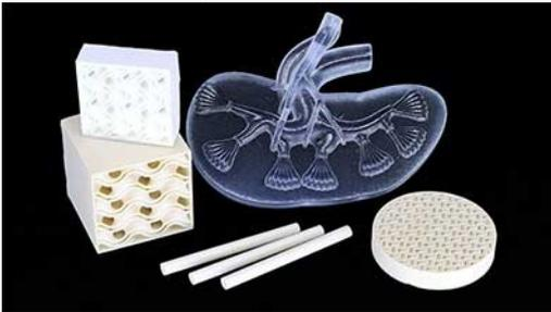
Ein Highlight am Stand der Ernst-Abbe-Hochschule (EAH) Jena sind verschiedene komplexe, keramische Strukturen, die additiv aus einer keramischen Suspension durch das Digital Light Processing gefertigt wurden.
